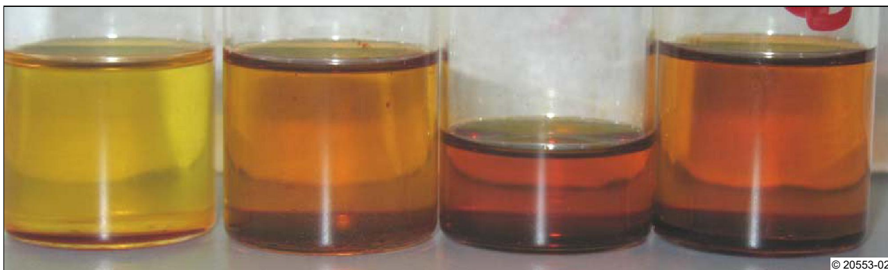
A2: Veränderung von reinem Biodiesel durch Lagerung bei 50 °C. Oxydierte Kraftstoffanteile färben den Biodiesel dunkel.
