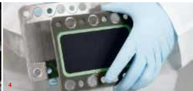
4 Brennstoffzelle Beim Brennstoffzellenantrieb erzeugt die Brennstoffzelle in einer chemischen Reaktion die elektrische Energie für einen Elektromotor, der ein Fahrzeug oder ein Gerät antreibt.
